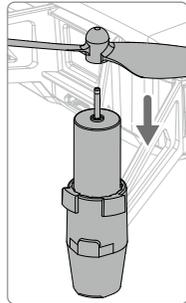
Installez les hélices non marquées sur les moteurs avec un train d'atterrissage non marqué.
