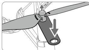
⚠ Détachez toujours les hélices en utilisant l'outil de retrait d'hélice. Ne retirez PAS les hélices à la main : vous pourriez gravement vous blesser ou endommager les moteurs.
