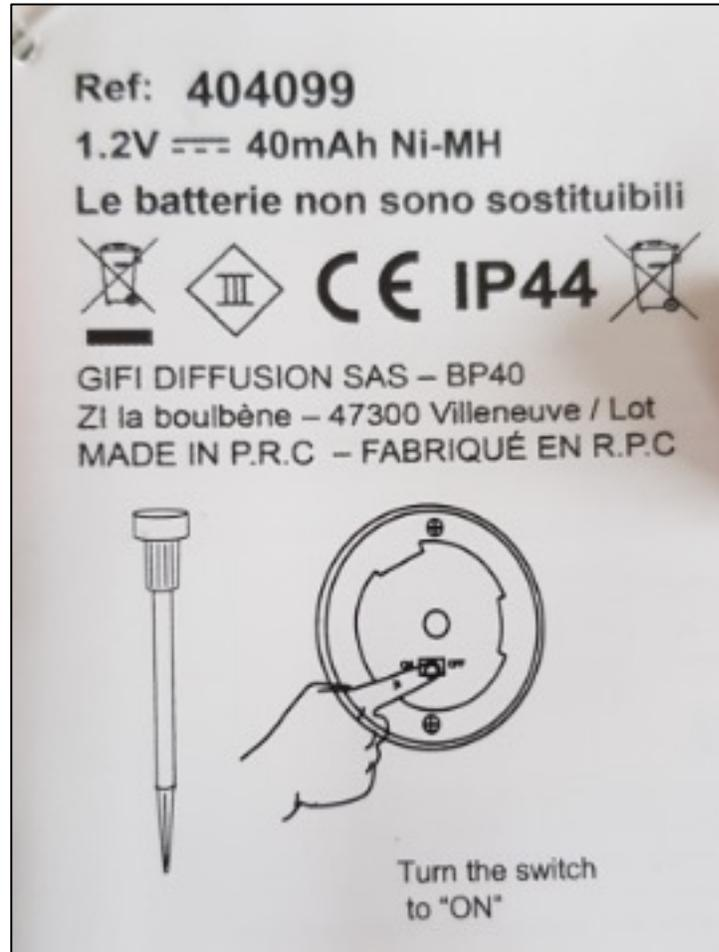
La capacité des piles est indiquée en **mAh** (milliampères/heure). Prenons par exemple une pile rechargeable Ni-MH d'une capacité de 40 milliampères/heure. Si vous insérez la pile dans un appareil qui consomme 20 milliampères de courant en continu, le temps de fonctionnement de l'appareil sera d'environ 2 heures.
