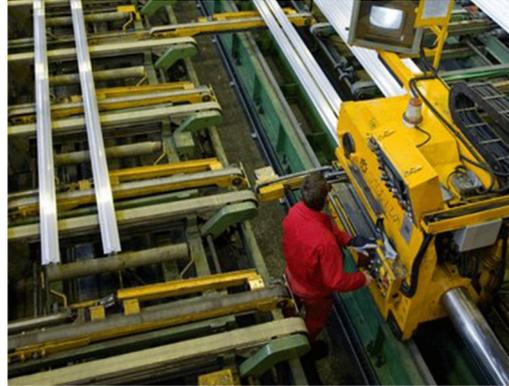
**Le filage** consiste à placer du métal solide chauffé dans un conteneur et de le faire ressortir par un orifice plus petit en exerçant une poussée. À partir d'un certain effort, il y a écoulement plastique à travers la filière.
