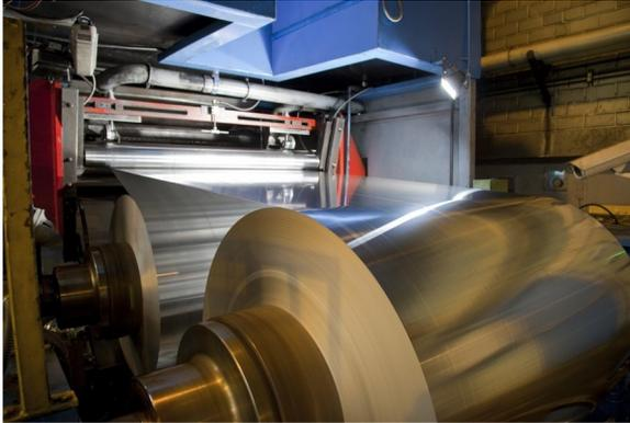
**Le laminage** consiste à réduire l'épaisseur d'une plaque de métal par passages successifs entre des cylindres, qui vont à la fois écraser et étirer l'aluminium.
