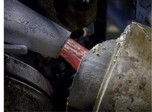
**La fonderie** consiste à couler un métal ou un alliage liquide dans un moule afin de reproduire une pièce (dans ses formes intérieures et extérieures) en limitant autant que possible les travaux de finitions
